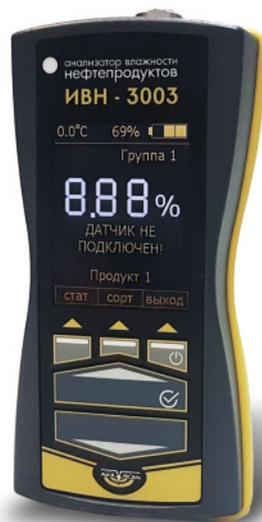
Измеритель влажности нефтепродуктов ИВН-3003 предназначен для экспресс-измерения влажности проб обратных эмульсий, образованных нефтепродуктом и водой. Новая модернизированная версия популярного влагомера ИВН-2003.
