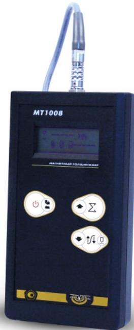
Магнитный толщиномер покрытий MT-1008 предназначен для измерения толщины лакокрасочных, гальванических, огнезащитных и любых других немагнитных токопроводящих и непроводящих покрытий на ферромагнитных (сталь, чугун и пр.) основаниях. Портативный недорогой прибор для экспресс - контроля.
