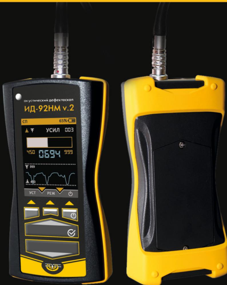
Дефектоскоп предназначен для акустического контроля изделий из композитных и других материалов с большим затуханием с помощью импедансного метода и метода свободных колебаний, на предмет определения расслоений, непроклеев, внутренних дефектов в изделиях из слоистых пластиков, композитных и сотовых материалов. Внесен в Госреестр СИ
