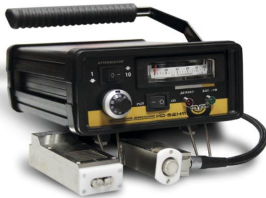
Акустический дефектоскоп ИД-92НМ предназначен для акустического контроля изделий из композитных и других материалов с большим затуханием с помощью импедансного метода и метода свободных колебаний, на предмет определения расслоений, непроклеев, внутренних дефектов в изделиях из слоистых пластиков, композитных и сотовых материалов. Внесен в Госреестр СИ.
